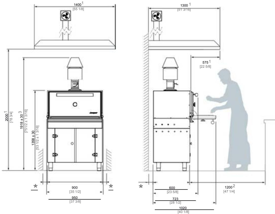
\* DISTANCE MINIMUM PAR RAPPORT AUX ÉLÉMENTS INFLAMMABLES : 300 mm [12 po] / DISTANCE RECOMMANDÉE PAR RAPPORT AUX AUTRES ÉLÉMENTS : 100 mm [4 po]
