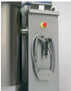
Douchette montée sur l'avant de la colonne avec mélangeur au dessus
