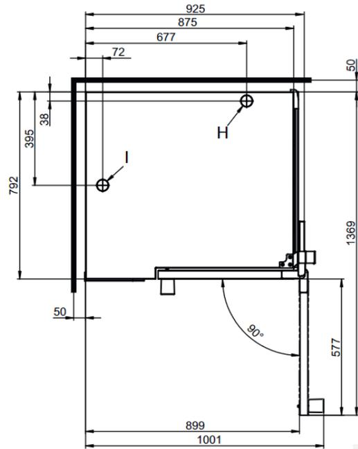
Positions de raccordement au fond de l'appareil
