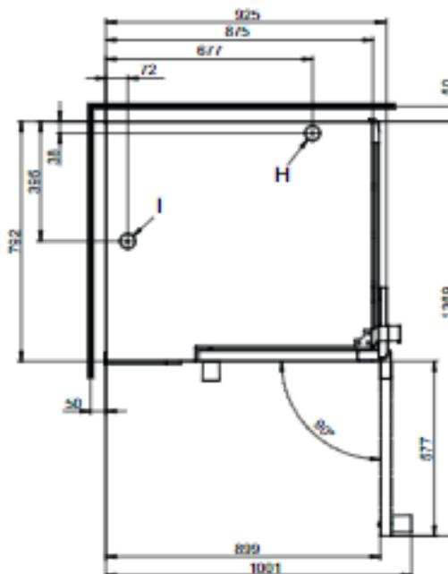
Positions de raccordement au fond de l'appareil
