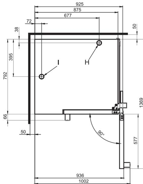
Positions de raccordement au fond de l'appareil
