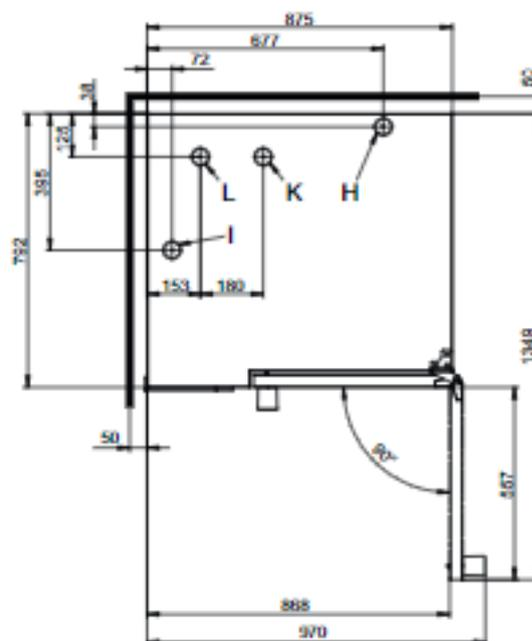
Positions de raccordement au fond de l'appareil
