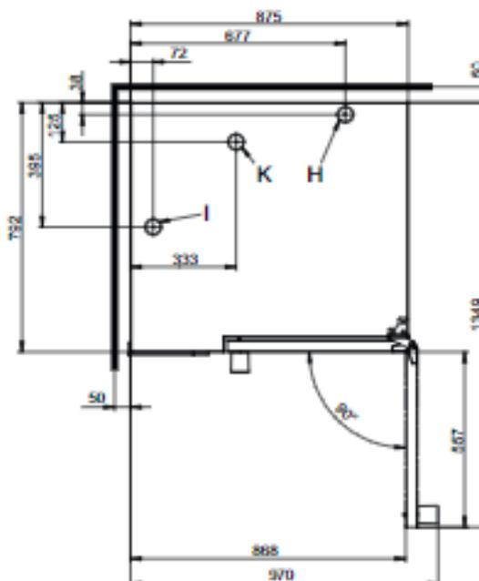
Positions de raccordement au fond de l'appareil
