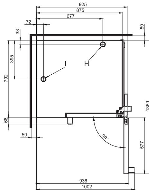
Positions de raccordement au fond de l'appareil
