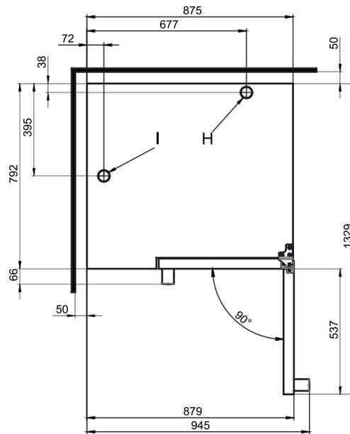
Positions de raccordement au fond de l'appareil
