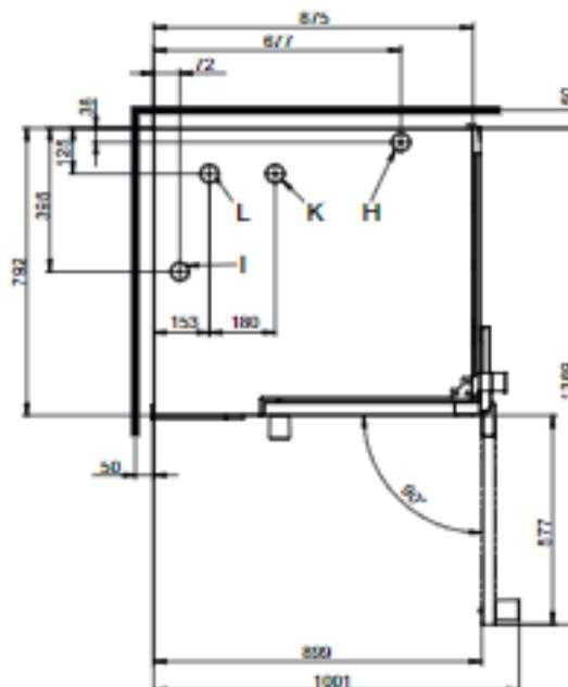
Positions de raccordement au fond de l'appareil
