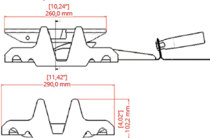
Ouverture de la presse : Hauteur maximale des aliments
