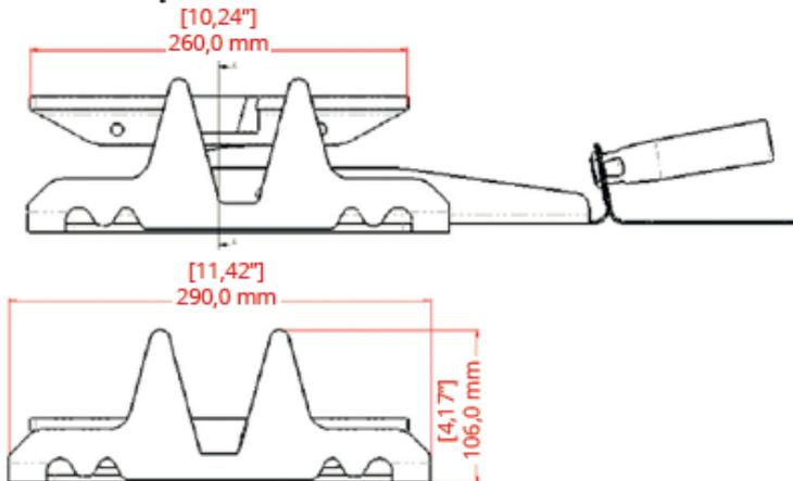
Ouverture de la presse : Hauteur maximale des aliments
