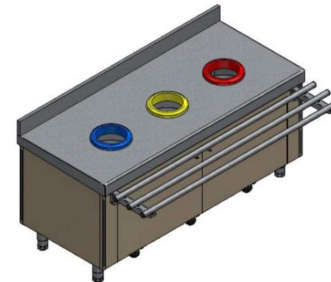
Construction inox Aisi 304. Dessus inox Aisi 304, ép. 20/10e. Bord avant rayonné. Façade stratifiée à 15 mm du sol et rampe inox 3 lisses incluses, rabattable vers le haut.
